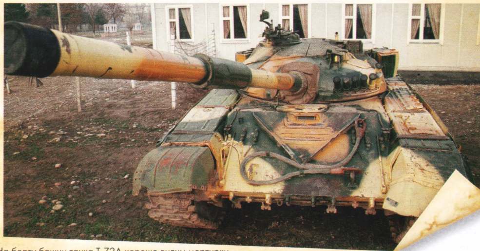
На борту башни танка Т-72А хорошо видны мортирки системы пуска дымовых гранат 902А «Туча-1».
