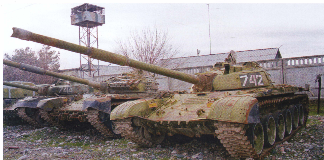
Отслуживший свой век танк Т-72 (крайний справа). Хорошо видно крепление для установки оборудования для самоокапывания на переднем листе корпуса.
